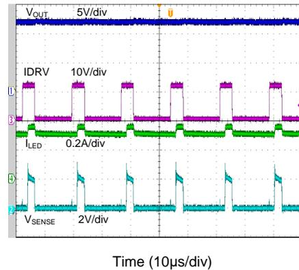
Steady Waveform ( $V_{IN(AC)}=110V$ )
