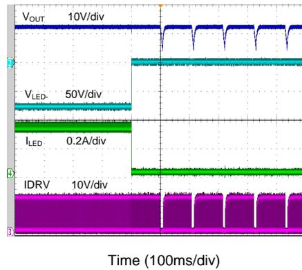
**Steady Waveform ( $V_{IN(AC)}=110V$ )**
