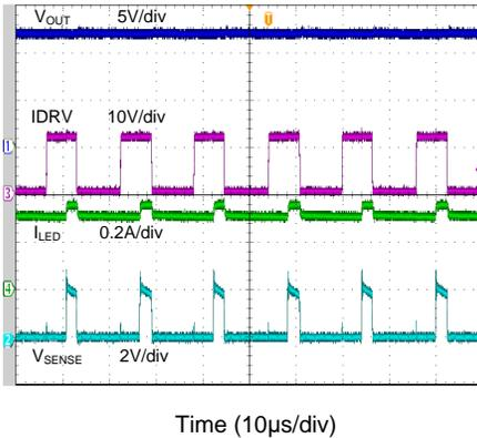
**Steady Waveform ( $V_{IN(AC)}=220V$ )**
